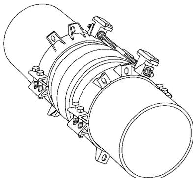
4. Pour terminer l'ensemble tige filetée/glissière, serrez les écrous contre l'oreille de retenue et le bloc de glissière. **Ne pas trop serrer les écrous de fixation sur les tiges filetées.**
