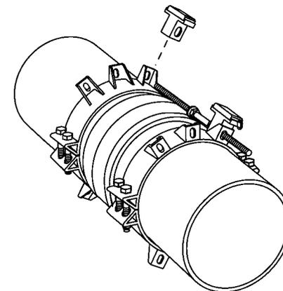
3. Pour assembler la deuxième glissière, placez la glissière sur l'oreille de l'anneau de retenue et faites glisser la tige à travers les fentes de la glissière et de l'oreille de l'anneau de retenue.
