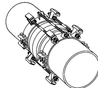
6. Terminez l'installation en plaçant les tiges filetées restantes en place à travers les oreilles de l'anneau de retenue. Remarque : Les tiges filetées sans patins n'ont pas d'écrous intérieurs. **ne pas trop serrer les écrous de fixation des tiges filetées.**
