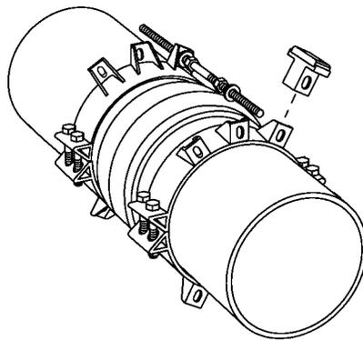
2. Connectez les dispositifs de retenue avec des tiges filetées. Enfillez un écrou (suivi d'une rondelle) de chaque extrémité de la tige à la tige de la tige. Assemblez le patin sur l'oreille de l'anneau de retenue au fur et à mesure que la tige passe dans le trou. Installez une rondelle et un écrou derrière l'oreille du dispositif de retenue et contre l'intérieur du bloc de guidage. Voir encart ci-dessous.
