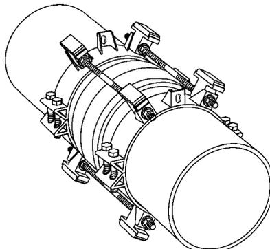
5. Installez le deuxième jeu de glissières. Répétez les étapes #2, #3 et #4. **Ne pas trop serrer les écrous de fixation sur les tiges filetées.**
