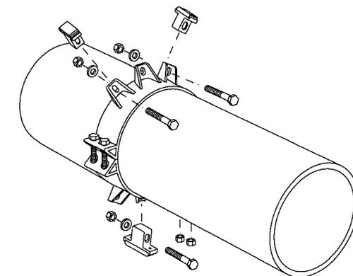
2. Placez la glissière sur l'oreille de l'anneau de retenue et faites glisser le boulon hexagonal dans la fente. Placez une rondelle sur le boulon et serrez avec l'écrou contre celui-ci.
