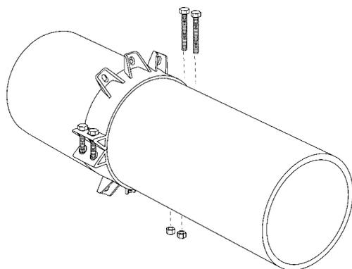
1. Assemblez l'anneau de retenue sur le tuyau. Serrez les boulons de serrage en alternance (maintenez l'écart entre les moitiés du dispositif de retenue même des deux côtés) au couple recommandé indiqué sur le dispositif de retenue.
