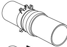
1. Assemblez le raccord en cloche du tuyau. Faites glisser l'anneau de retenue 1350 sur la longueur du tuyau jusqu'à ce qu'il repose contre l'arrière de la cloche du tuyau. Assurez-vous que le bord biseauté fait face à la cloche.
