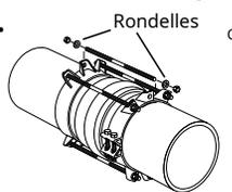
3. Connectez 1300 à 1350 avec toutes les tiges fournies. Utilisez une rondelle derrière chaque oreille, installez l'écrou derrière la rondelle et serrez les écrous de retenue à la main, puis un tour. **Ne pas trop serrer les écrous de fixation.**
