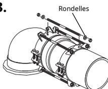
3. Connectez les deux anneaux de retenue avec toutes les tiges fournies. Placez une rondelle derrière les oreilles du dispositif de retenue. Serrez tous les écrous de retenue à la main, puis un tour. **Ne pas trop serrer les écrous de fixation.**
