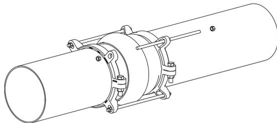
4. Insérez les bielles dans les fentes et serrez les écrous de connexion à la main. **Ne serrez pas trop les écrous de connexion.**
