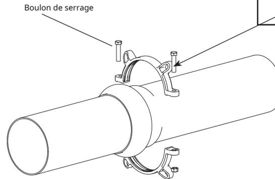
2. Assemblez la moitié du dispositif de retenue dentelé des séries 1390-x-DWB / 1399-x directement derrière la cloche du tuyau. Serrez uniformément les boulons et les écrous de serrage au couple recommandé pour votre type de tuyau, comme indiqué dans le tableau 1.
