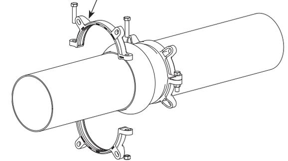
3. Assemblez la retenue dentelée restante sur l'extrémité mâle du tuyau en utilisant les tiges de connexion comme guide pour la position. Serrez uniformément les boulons de serrage au couple recommandé pour votre type de tuyau, comme indiqué dans le tableau 1.
