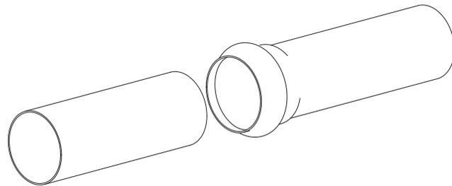
1. Assemblez l'extrémité du tuyau à emboîtement sur la cloche en suivant la procédure standard, en suivant les recommandations du fabricant du tuyau.
