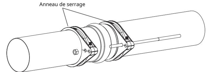
4. Insérez les bielles dans les fentes et serrez les écrous de connexion d'1/2 tour au-delà du serrage à la main. (Pour 10" et 12", utilisez les deux fentes extérieures.) **Ne serrez pas trop les écrous de raccordement.** **Note:** L'anneau de serrage peut être assemblé autour des tiges pour faciliter l'alignement de contention à contention. Utilisez des écrous supplémentaires (non inclus) à l'intérieur des trous des boulons de retenue si le joint de tuyau est suspecté de se contracter.
