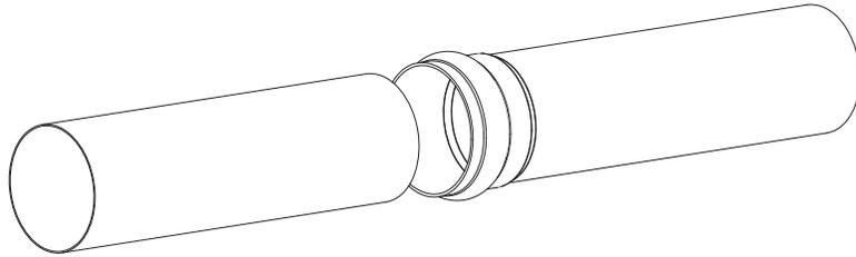
1. Assemblez l'extrémité du tuyau à emboîtement sur la cloche en suivant la procédure standard, en suivant les recommandations du fabricant du tuyau.
