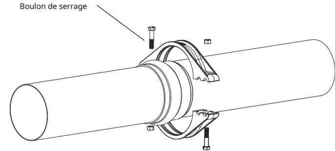
2. Assemblez la moitié du dispositif de retenue dentelé de la série 1399-x directement derrière la cloche du tuyau. Serrez uniformément les boulons et les écrous de serrage au couple recommandé comme indiqué dans le tableau 1. L'utilisation d'une clé dynamométrique est fortement recommandée et nécessaire pour garantir un couple approprié.
