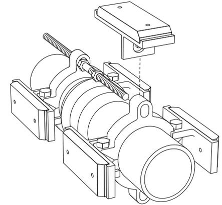
4. Installez (2) écrous sur les tiges filetées. Enfilez un écrou de chaque extrémité de la tige filetée à la tige de la tige. Insérez la tige filetée et le coulisseau comme indiqué. (Voir encart ci-dessous)
