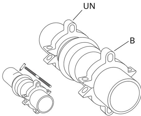
1. Retirez les boulons de plaquette de serrage standard de l'anneau de retenue et jetez-les. Positionnez un anneau de retenue UFR1300 sur l'embout mâle du tuyau et juste derrière l'extrémité de la cloche, comme illustré. (utilisez des tiges filetées comme guide pour positionner les dispositifs de retenue) Assurez-vous que les oreilles des bagues de retenue A et B sont correctement alignées.
