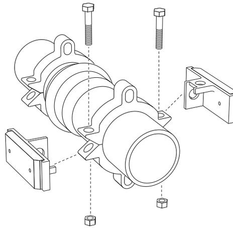
2. Placer les glissières sur les patins de serrage. Insérez des boulons de plaquette de serrage plus longs à travers le dispositif de retenue et la glissière et serrez les écrous uniformément pour couples recommandés.
