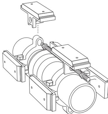
5. Installez la glissière suivante. Les glissières ont des guides de fonte conçus pour correspondre à l'anneau de retenue. Insérez les tiges filetées et le coulisseau comme illustré.
