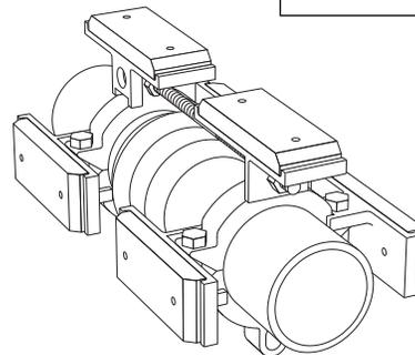
6. Une fois les patins, les tiges filetées et les écrous en place, serrez les écrous derrière les dispositifs de retenue. **Ne pas trop serrer les écrous des tiges filetées.**
