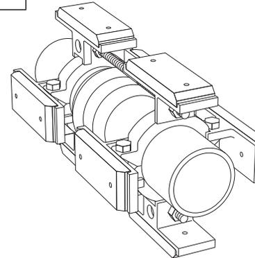
7. Installez le deuxième jeu de glissières. Répétez les étapes #4, #5 et #6. Insérez les glissières, les tiges filetées et les écrous comme indiqué et serrez les écrous derrière les dispositifs de retenue. **Ne pas trop serrer les écrous des tiges filetées.**
