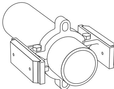
3. Avec les glissières sur les oreilles de l'anneau de retenue, serrez les écrous uniformément au couple recommandé indiqué ci-dessous. L'anneau de retenue assemblé avec les glissières doit apparaître comme illustré ci-dessus.
