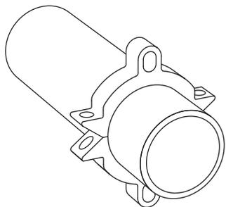
1. Retirez les boulons de plaquette de serrage standard de l'anneau de retenue et jetez-les. Placez l'anneau de retenue UFR1300 sur le fût du tuyau. Localisez l'anneau entre les joints en cloche du tuyau (recommandé tous les dix pieds le long du pipeline).
