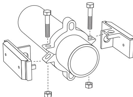
2. Assemblez l'anneau de retenue avec les glissières comme indiqué ci-dessus. Utilisez les boulons de serrage plus longs fournis dans le kit.
