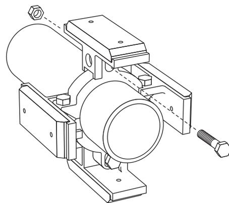
4. Installez les autres glissières de l'anneau de retenue. Le coulisseau a des guides moulés conçus pour correspondre à l'oreille de l'anneau de retenue. Insérez le boulon à tête hexagonale et serrez l'écrou comme illustré.
