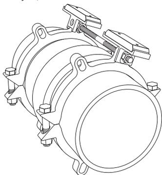
4. Pour terminer l'assemblage tige filetée / glissière, serrer les écrous de la tige filetée contre les glissières. **Ne pas trop serrer les écrous de fixation des tiges filetées.**
