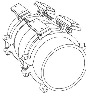
5. Installez le deuxième jeu de glissières. Répétez les étapes #3 et #4. **Ne pas trop serrer les écrous de fixation des tiges filetées.**
