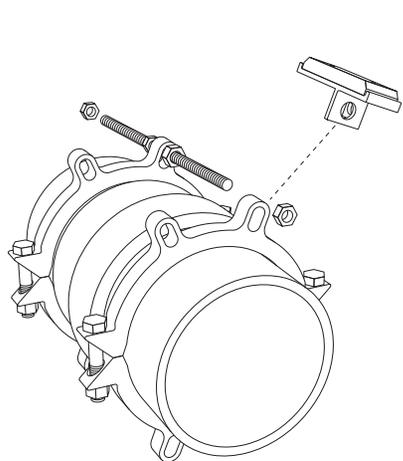
2. Vissez un écrou de chaque extrémité de la tige filetée à la tige de la tige. (Voir encadré ci-dessous) Connecter les brides avec des tiges filetées. Assemblez le patin sur l'oreille de l'anneau de retenue au fur et à mesure que la tige passe dans le trou.
