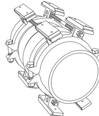
6. Terminez l'installation en plaçant les tiges filetées restantes en place à travers les oreilles de l'anneau de retenue. **Ne pas trop serrer les écrous de fixation des tiges filetées.**
