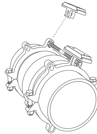
3. Pour assembler la deuxième glissière, placez la glissière sur l'oreille de l'anneau de retenue et faites glisser la tige à travers les fentes de la glissière et de l'oreille de l'anneau de retenue.
