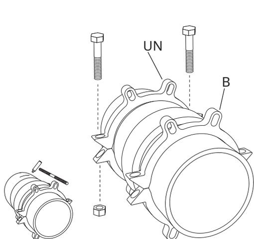
1. En utilisant l'une des tiges filetées et des glissières comme guide, positionner les deux anneaux de retenue UFR1300 et les installer sur le tuyau, un derrière la cloche et un sur le bout uni. Assurez-vous que les oreilles de l'anneau de retenue A et B sont correctement alignées. Serrez les boulons de serrage uniformément à 200 lb-pi. (L'assemblage des moitiés de retenue peut être effectué avant de réaliser le joint de tuyau.)
