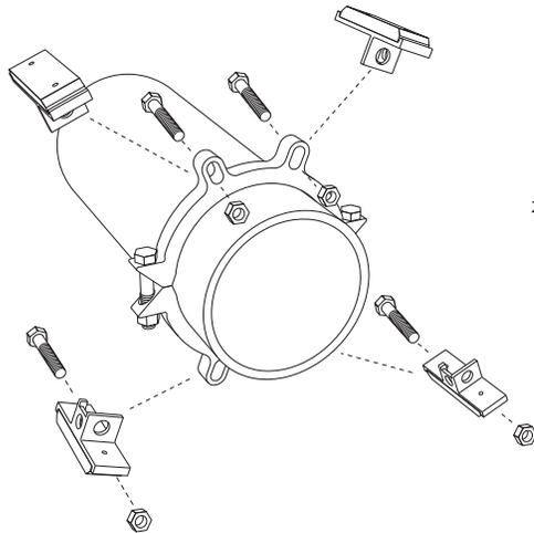
2. Placez la glissière sur l'oreille de l'anneau de retenue et faites glisser le boulon à tête hexagonale dans la fente. Serrez fermement l'écrou hexagonal.
