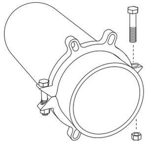
1. Assemblez l'anneau de retenue UFR1300 sur le tuyau, serrez les boulons de serrage uniformément à 200 lb-pi.
