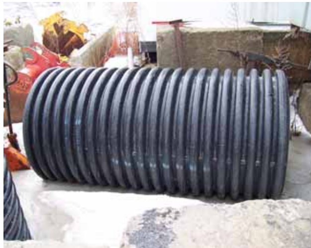
Figure 12 - Le tuyau en polyéthylène haute densité (PEHD) (Source : Lan et al, 2003)
